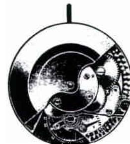
**Mouvement ancre, avec remontage automatique, seconde au centre, double date, remise en date rapide**
