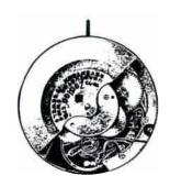
Mouvement ancre, avec remontage automatique, seconde au centre
