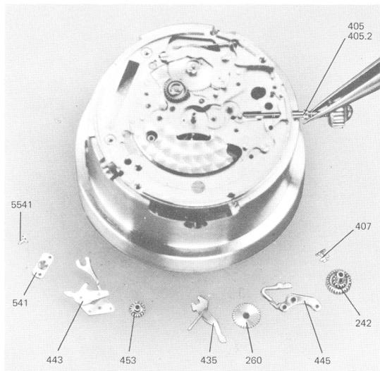
8.1.10 Dévisser la vis (5541), déposer la plaquette de maintien de tirette 541, soulever délicatement, puis déposer la tirette montée 443 et le renvoi intermédiaire 453.
