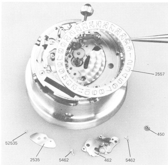
8.1.8 Dévisser la vis (52535) et déposer la plaque de maintien de l'indicateur de quantité 2557.
