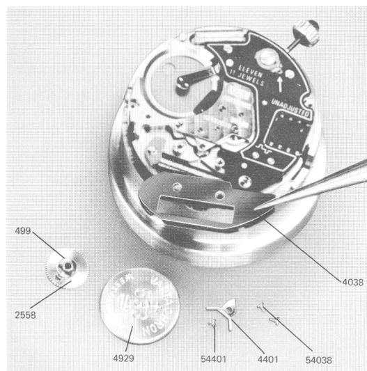
8.1.4 Dévisser les quatre vis (54000) et déposer le module électronique 4000 en prenant garde de ne pas blesser le fil de la bobine.
