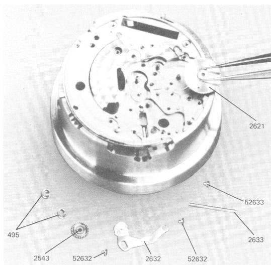
8.1.12 Pousser et déposer les deux clavettes 495; déposer la roue intermédiaire de quantité 2543. Dévisser les deux vis (52632) et déposer la bascule de déclenchement de quantité montée 2632 (ne pas la démonter).
