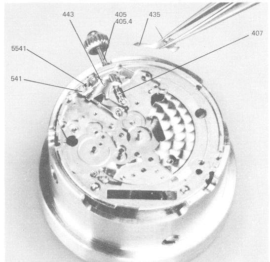
8.4.2 Lubrifier et poser le renvoi intermédiaire 453. A cet effet, soulever à l'aide d'un tournevis l'extrémité du ressort de la tirette, et insérer dans la fourchette la gorge du renvoi intermédiaire (denture en haut) puis, relâcher la pression lorsque le renvoi pivote sur son tenon.
