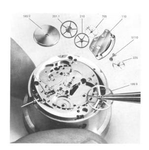
8.1.9 Dévisser la vis (5462). Déposer dans l'ordre: le pont de rouage de minuterie 462, la roue de minuterie 260, le renvoi 450, le sautoir de quantième 2576 et la chaussée lanternée 240 ou 245 montée sur la chaussée non lanternée 243.
