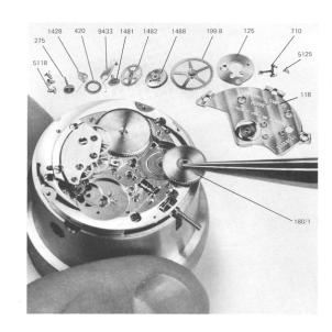
8.1.8 Dévisser les deux vis (5110). Déposer dans l'ordre: le pont de rouage 110, la roue de seconde 220, la roue d'ancre 705, la roue de grande moyenne 201.1, la roue moyenne 210, le grand barillet complet 180/2 et l'axe du grand barillet 199.9.
