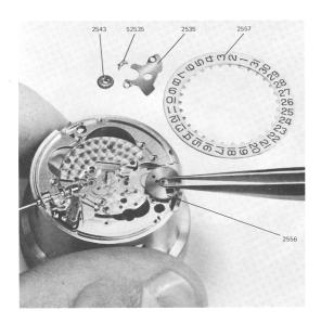
8.1.10 Dévisser les deux vis (52535). Déposer dans l'ordre: la plaque de maintien de l'indicateur de quantième 2535, l'indicateur de quantième 2557, la roue intermédiaire de l'indicateur de quantième 2543 et la roue entraîneuse de l'indicateur de quantième 2556.
